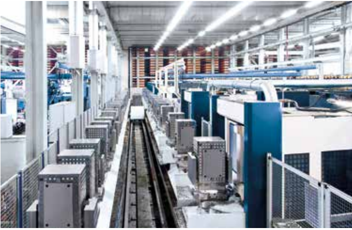
Bearbeitungszentrum mit Würfel-Aufspannvorrichtungen, Firma Meusburger
