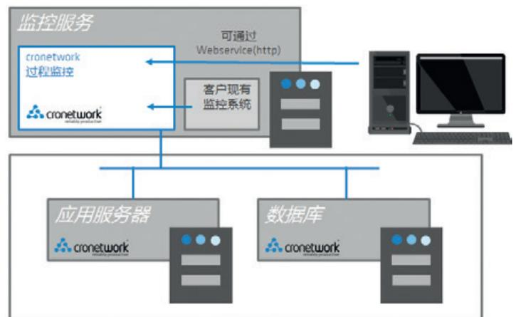
您可以通过多种多样的方式将Cronetwork的监控功能与现有系统进行集成
